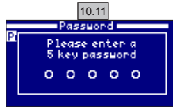
10.11 Пароль: позволяет защитить доступ к меню пользователя паролем. Чтобы указать свой пароль, введите комбинацию из 5 клавиш. Система их сохранит. Если вы забудете пароль, существует «главный пароль». Свяжитесь с установщиком/поставщиком.
